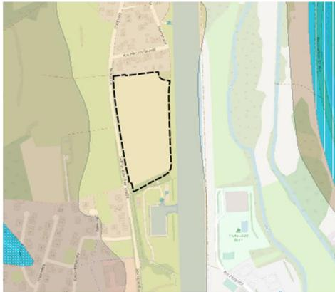
*Abb. links: Nach der Geologischen Karte von Bayern liegt die geplante Baumaßnahme im Verbreitungsgebiet von pleistozänen Flussablagerungen (Quartär) aus Sand und Kies (z.T. unter Flusslehm und Flussmergel).*
